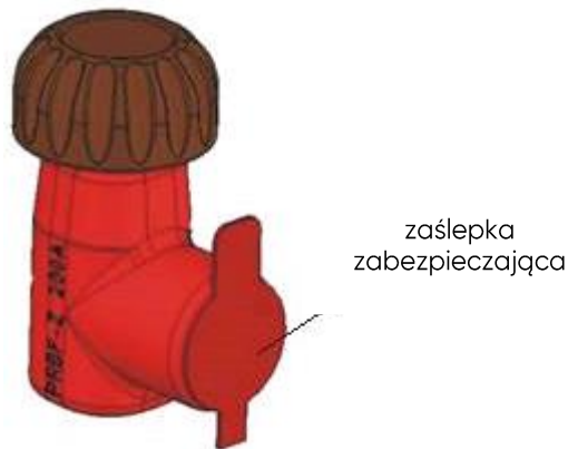
Rys. 4 Zabezpieczenie gniazda zaślepką
