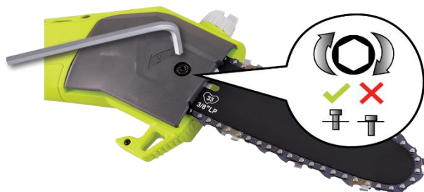
Rys. 7 Poluzować śrubę osłony koła łańcuchowego
